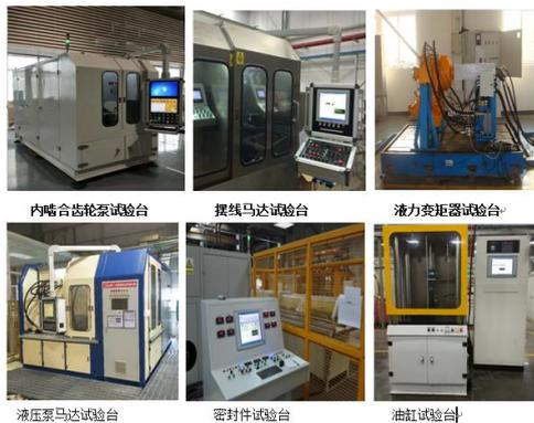
高效节能型液压元件测控系列装置
