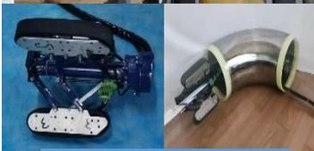
薄壁结构件制孔机器人
